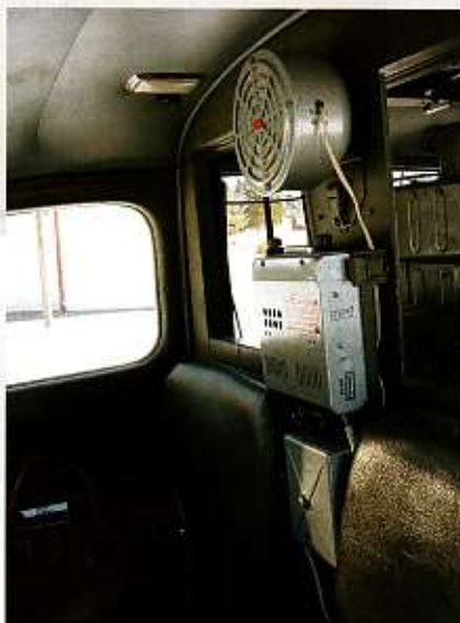
De MT 920 met box en transformator.
